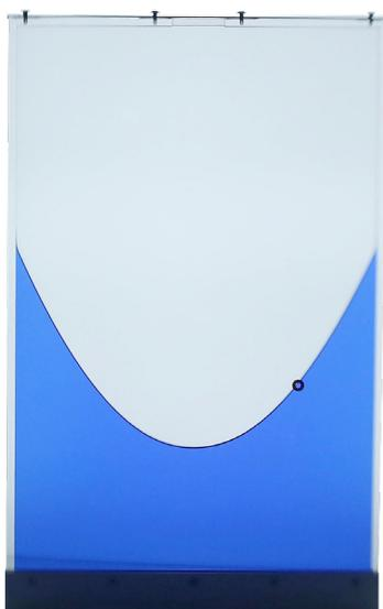
Drehe am schwarzen Drehknopf. Du kannst einstellen, wie schnell sich der mit blauer Flüssigkeit gefüllte Glasbehälter drehen soll. Probiere verschiedene Geschwindigkeiten aus. Zeichne die entstehende Form der Flüssigkeit in die Kästchen.
