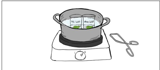
8. Drehe die Temperatur der Heizplatte etwas zurück. Im nächsten Arbeitsschritt wird mit einer Temperatur von 80 °C gearbeitet. Hänge zur Überprüfung der Temperatur ein Thermometer in das Wasserbad.
